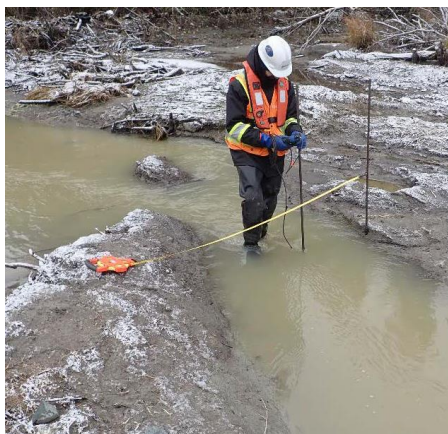
Station de mesure de débit (jaugage)
