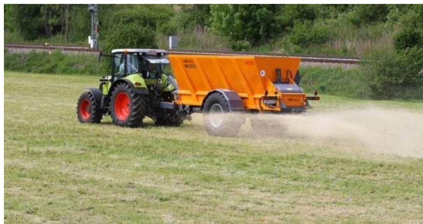
Chaulage des parcs à résidus inactifs
