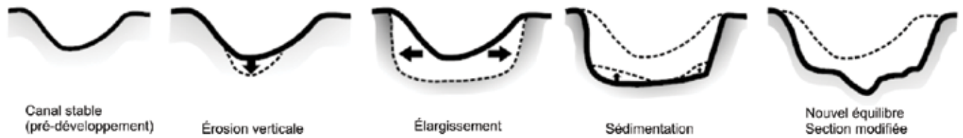
Figure 2.18 Processus de modifications géomorphologiques des cours d'eau en milieu urbain. (adapté de Amec et al. , 2001).
