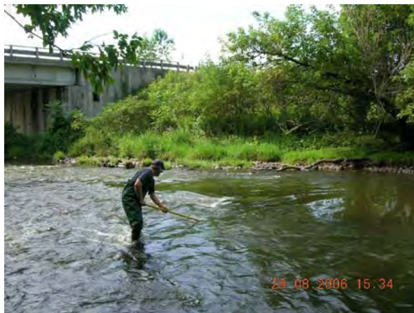
Photo 2 – Échantillonnage à la station en aval de Granby le 29 août 2006. Certains contaminants peuvent être analysés dans de plus petits volumes d'eau. L'échantillonnage se fait alors à l'aide d'une bouteille fixée à l'extrémité d'une perche.
