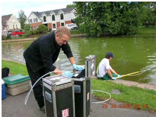
Photo 1 – Échantillonnage à la station en amont de Granby le 29 août 2006. La mesure des BPC, des dioxines et furanes chlorés, des HAP et de certains autres contaminants requiert le remplissage de 3 contenants de 18 litres en acier inoxydable. L'échantillon est prélevé à l'aide d'une pompe et d'un boyau qui permettent d'acheminer l'eau directement dans les contenants, lesquels sont placés dans des caissons de protection. Lors de cette tournée d'échantillonnage, l'exutoire du lac Boivin était envahi par des cyanobactéries.
