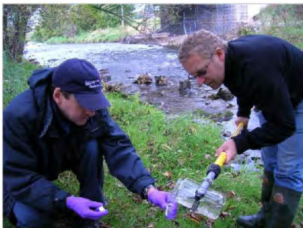
Photo 3 – Échantillonnage à la station en aval de Granby le 26 septembre 2006. Transvasement d'eau vers une petite bouteille prévue pour l'analyse des composés organiques volatils.
