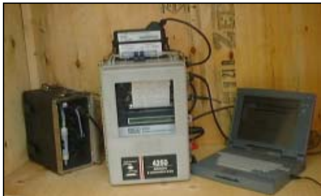
Figure 2.6 Débitmètres ISCO placés au régulateur Saint-Patrice
