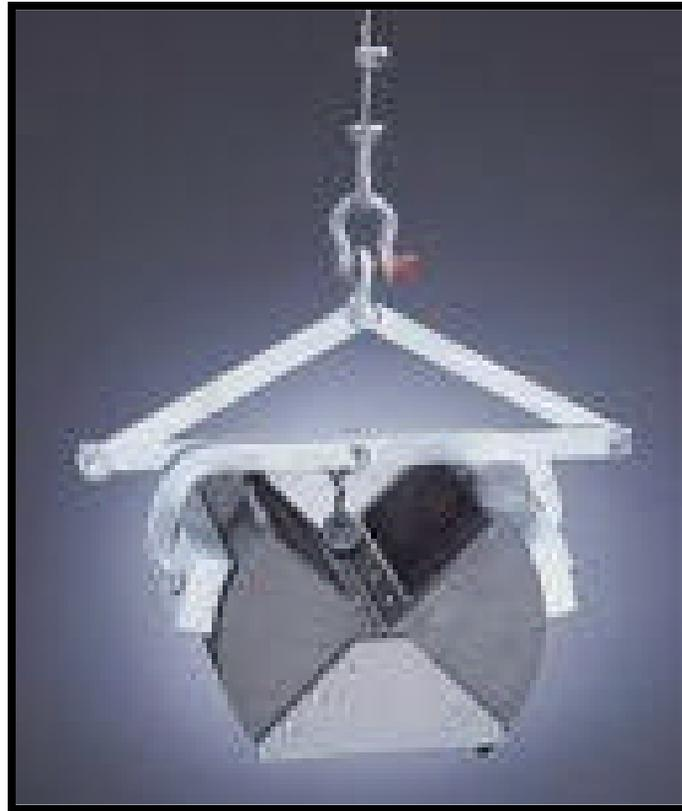
**Figure 2 :** Benne accrochée au treuil pour l'échantillonnage sédimentaire
