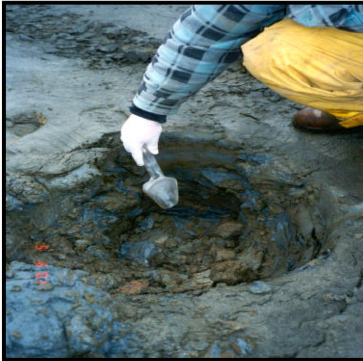
**Figure 4 :** Échantillonnage dans le parc à résidus miniers.
