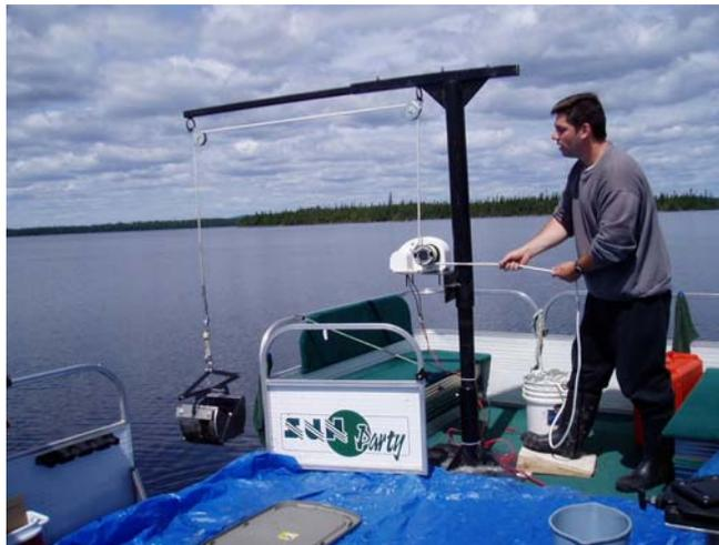
Figure 3 Échantillonnage des sédiments à l'aide de la benne Ponar
