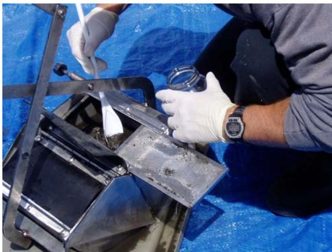
Figure 4 Prélèvement de l'échantillon de sédiments dans la benne Ponar
