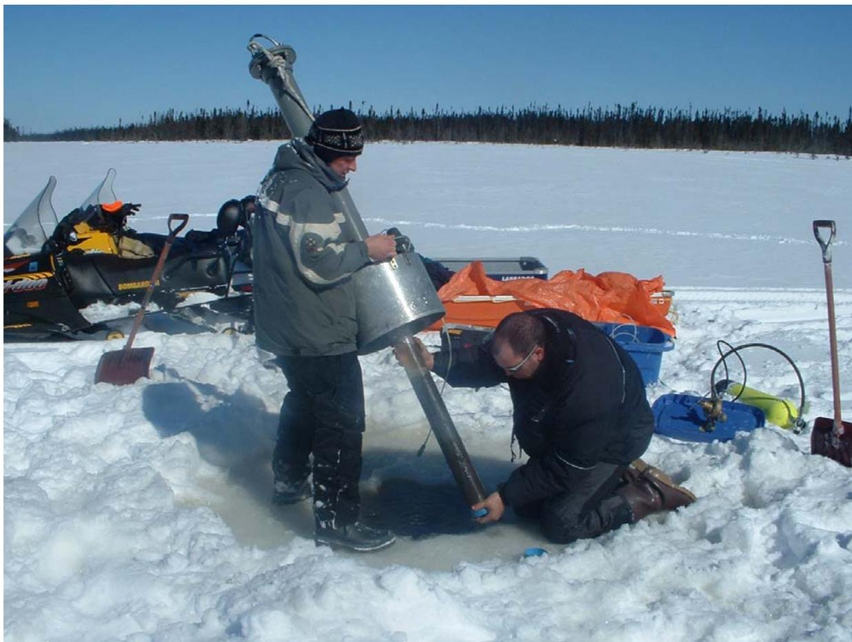
Figure 5 Prélèvement des carottes de sédiments à l'aide du carottier
