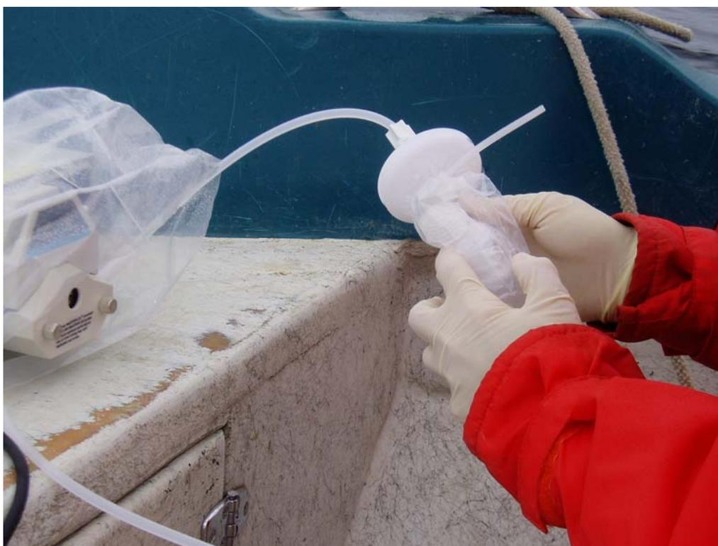
Figure 6 Prélèvement des échantillons d'eau pour l'analyse des métaux
