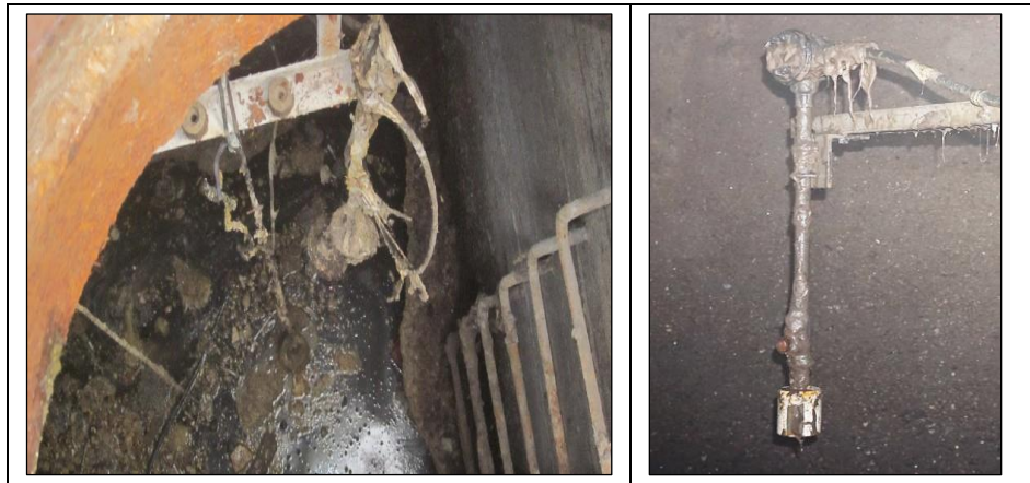
Figure 6-29. Exemples de capteurs très souillés qui sont mal entretenus
