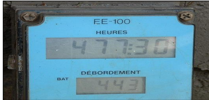
Figure 6-2. Compteur d'heures cumulatives (totalisateur)
