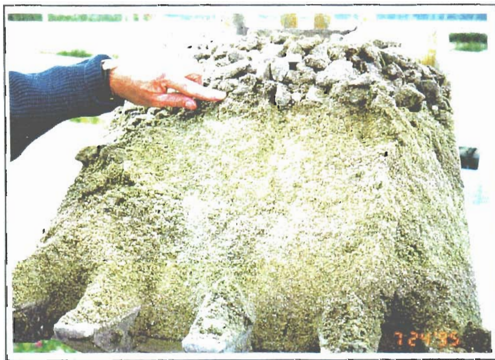
↑ L'excellent état du matelas biologique de l'élément épurateur n° 6
