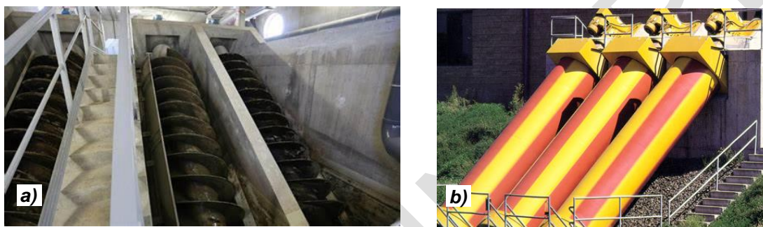
Figure 4.3.3-1 – Exemples de vis d'Archimède a) conventionnelles et b) fermées
