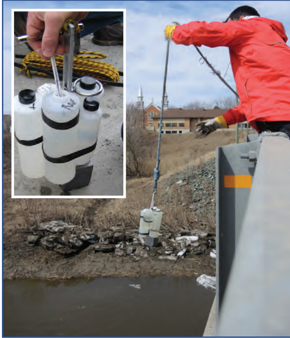
Prélèvement d'échantillons à partir d'un pont
